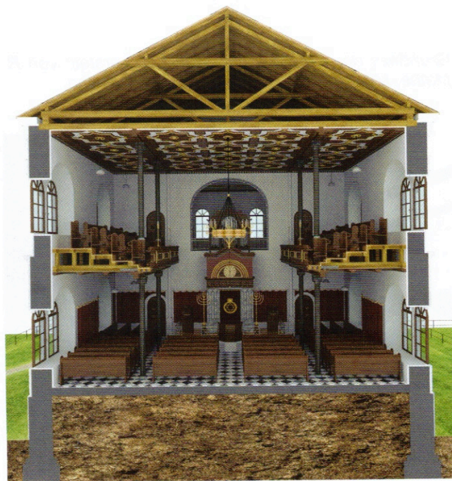
Querschnitt durch das Gebäude der alten Synagoge in Linz. Rendering von R. Mathe. Mit freundlicher Genehmigung R. Mathe.
