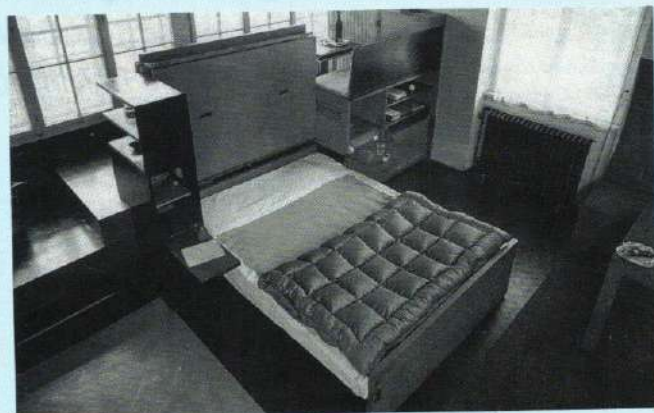
Tag, Nacht: Dachausbau Elsa und Erwin Reisner, Wien 18, Koschatgas-se 110, „arisiert“ durch Berta Florsch. Unter einem Podest lässt sich nachts das Doppelbett samt Nachttisch herausdrehen, tagsüber ver-wandelt sich das Podest in eine Sitzcke vor einem grossem Fenster mit Wienblick. Fotos: Georg Schrom, mit freundlicher Genehmigung.
