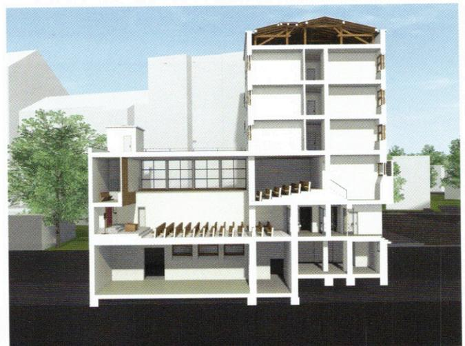
Längsschnitt durch das Gebäude. Sichtbar werden die Turnhalle, der Hauptraum mitsamt Emporen und Vorräumen, sowie die Wohngeschosse.<sup>2</sup>
